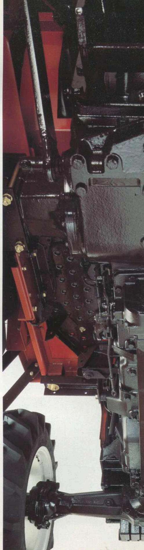
Version DT: Vue de dessous avec l'arbre de transmission coaxial et vérin de direction
