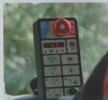
La pression dans le vérin de flèche est affichée sur le boîtier de l'épareuse.
