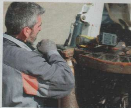
Les palpeurs sont réglés pour obtenir la même hauteur de coupe.
